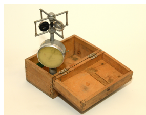
Anemometr czaszowy, prod. NRD, lata 50. XX w. z Katedry Ekologii i Klimatologii Leśnej Wydziału Leśnego, Fot. G. Wojcieszek
